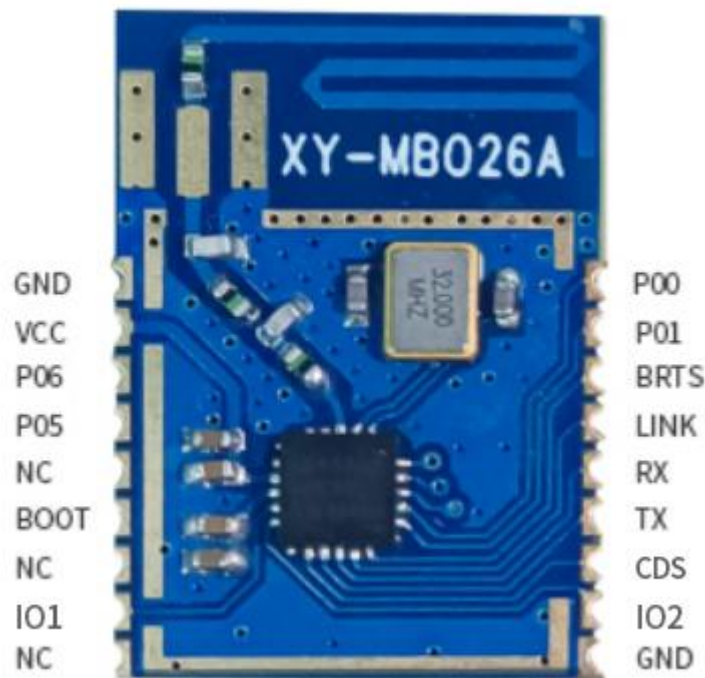
图 1-模块引脚图
