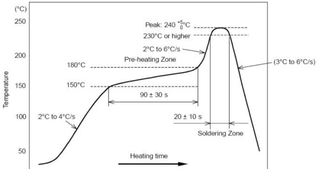
图 4-部件的焊接耐热性温度曲线(焊接点)
