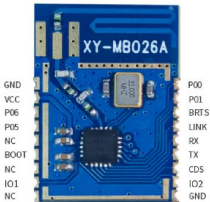
图 1-模块引脚图
